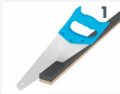
1. Isoleringsstolpen tilskæres med en fintandet sav.
