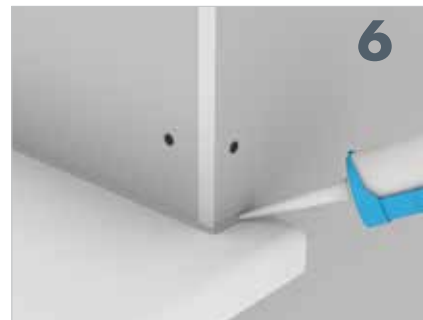
Efter montagen tættes med acrylfugemasse mellem elementet og de tilstødende flader.
